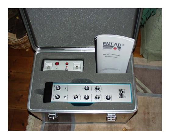
Schaumstoffgepolsterte - stoßgedämpfte Transportkiste für die Aufnahme des Gerätes EMFAD - UG12 - Pro, des Senders UG12 - TRX - 1 sowie dem Zubehör
